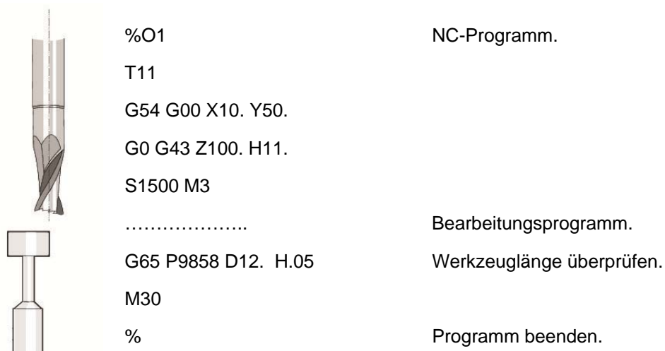
Abb. 6.3 Überprüfung eines Schaftfräasers
